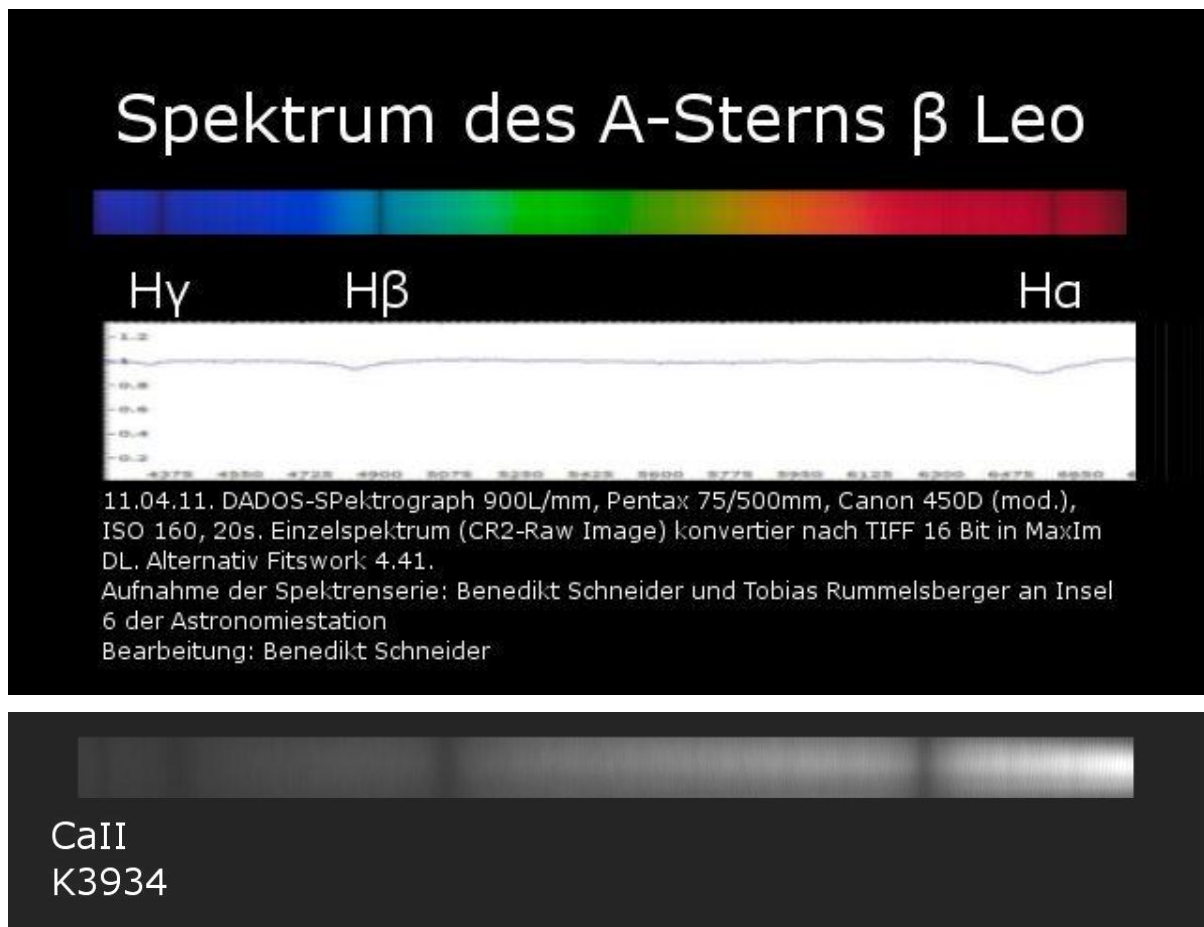
Abb. 5: Spektrum des Sterns \beta Leo, mit den markanten Wasserstofflinien H\alpha , H\beta und H\gamma und der Ca II K Linie (Unten: aufgenommen mit der ALCCD 5.2).
