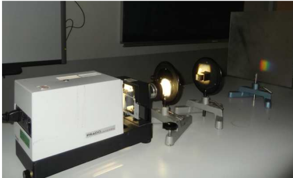
(5) Aufbau des Versuchs mit Dia-Projektor, Spalt, Prisma und Mattscheibe
