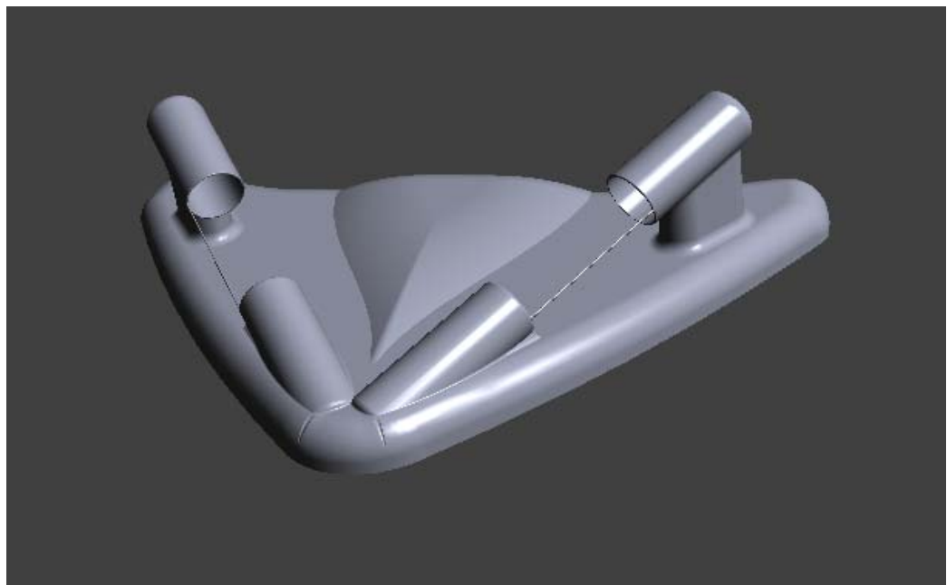
Abbildung 10: V-förmiger Aufbau des Sensorholders
