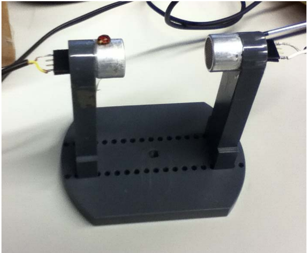
Abbildung 4: Umsetzung des Sensorholders (maschinelle Bearbeitung)
