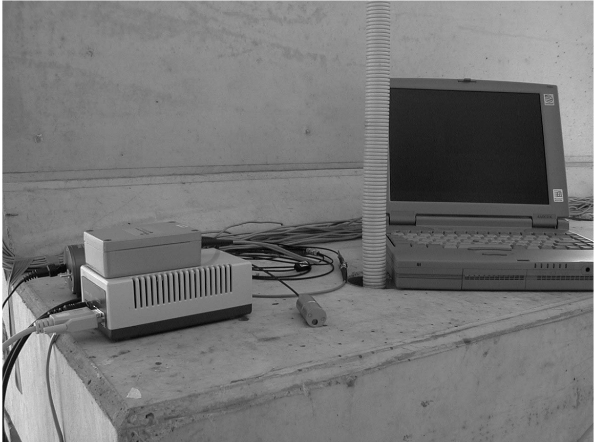
Abb. 4: Feuchtemessung an einem Ersatzbauwerk.
