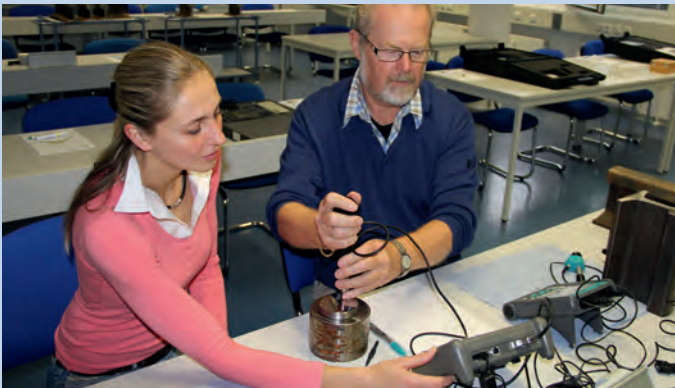
Justierung eines HT-Gerätes mit einem Vergleichskörper
