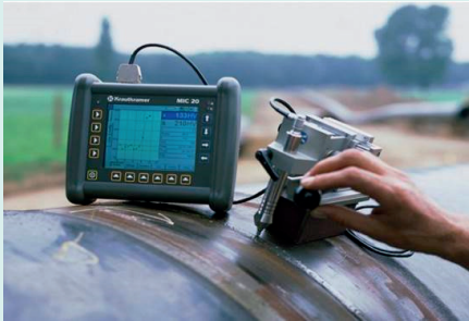
Härteprüfung an einer Schweißnaht im Pipelinebau (Bildquelle: Roger Marhöfer, Mannheim/ DGZfP-VNB 138/2018-12-05)
