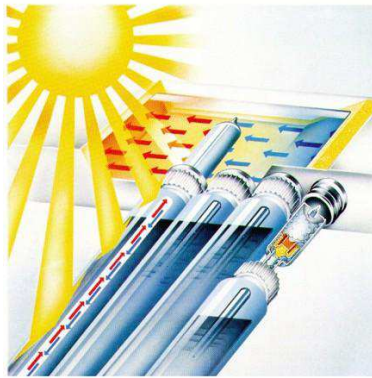
Abbildung 3: Funktionsschema eines indirekt durchströmten Röhrenkollektors
