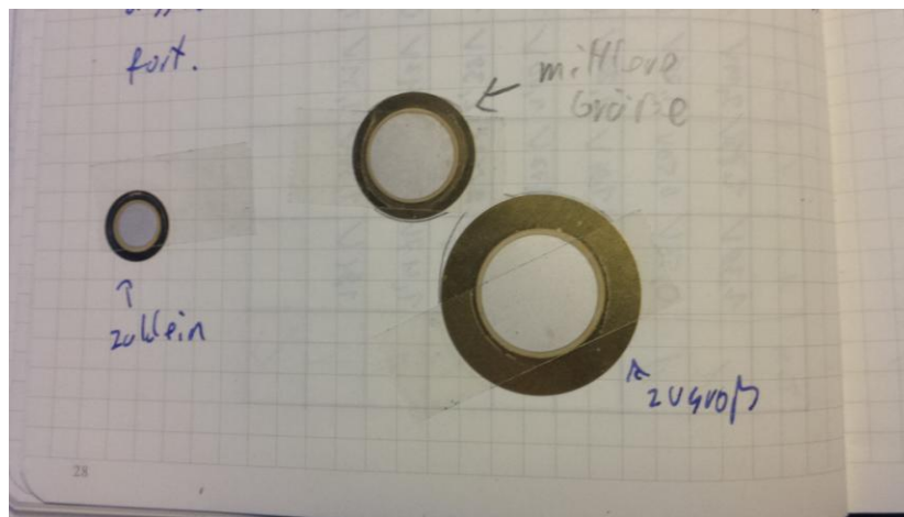
Abb. 4: Großer, mittlerer und zu kleiner Piezo
