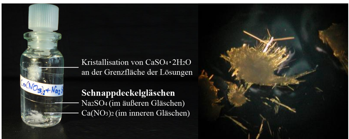
Abb. 5: Kristallisationsansatz nach Gläschenmethode
