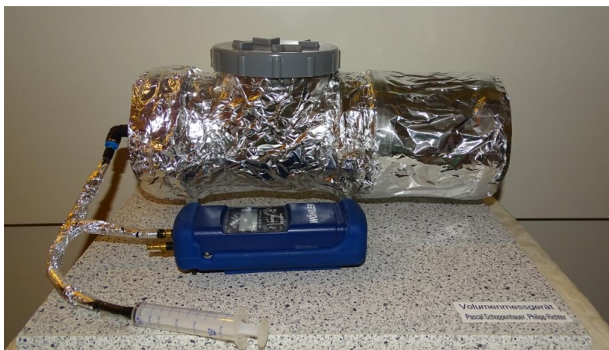
Abbildung 4: Verbesserter Messaufbau zur Volumenermittlung durch Luftdruck
