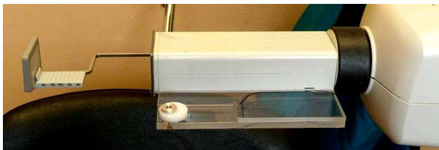
Abb. 11: Panoramaansicht der gesamten Röntgenanlage mit modifiziertem Tubus samt Blende und eingespanntem Filmhalter
