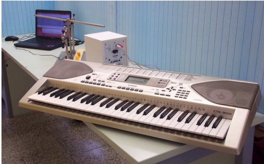
Abbildung 3: experimenteller Aufbau: Geräuscherzeugung (Keyboard und Lautsprecher), Aufnahme (Stativ mit Mikrofonen) und Auswertung (PC)
