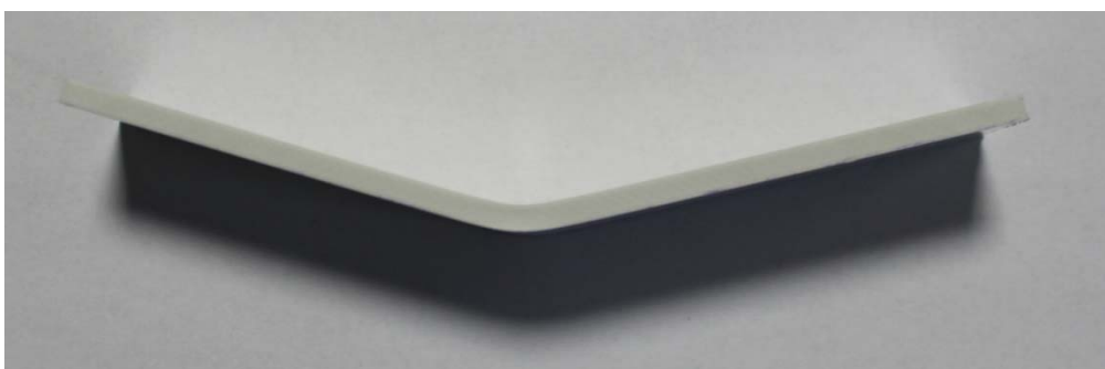
Abbildung 3–8: Aluminiumprobe nach der Biegung
