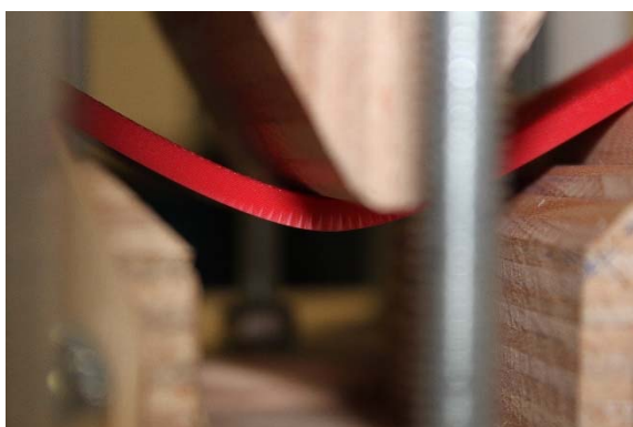
Abbildung 3–10: Risse an der Zugseite
