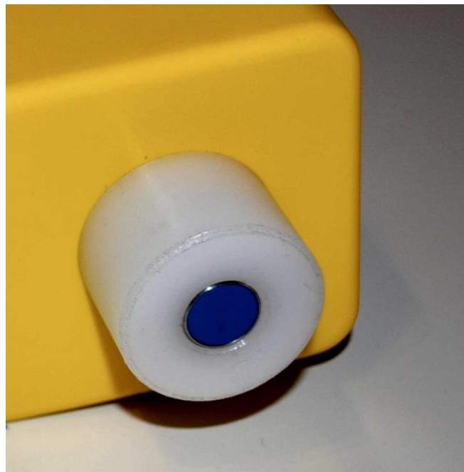
Verbauter Sensor mit PVC Schutzvorrichtung
